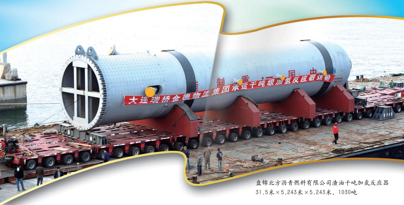
盘锦北方沥青燃料有限公司渣油千吨加氢反应器
