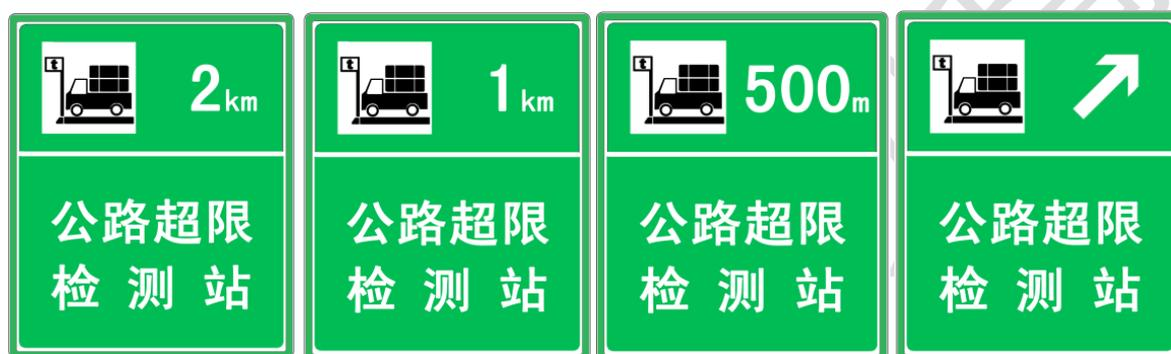
图 4.1-2 高速公路沿线公路超限检测站预告、指示交通标志参考示意图
