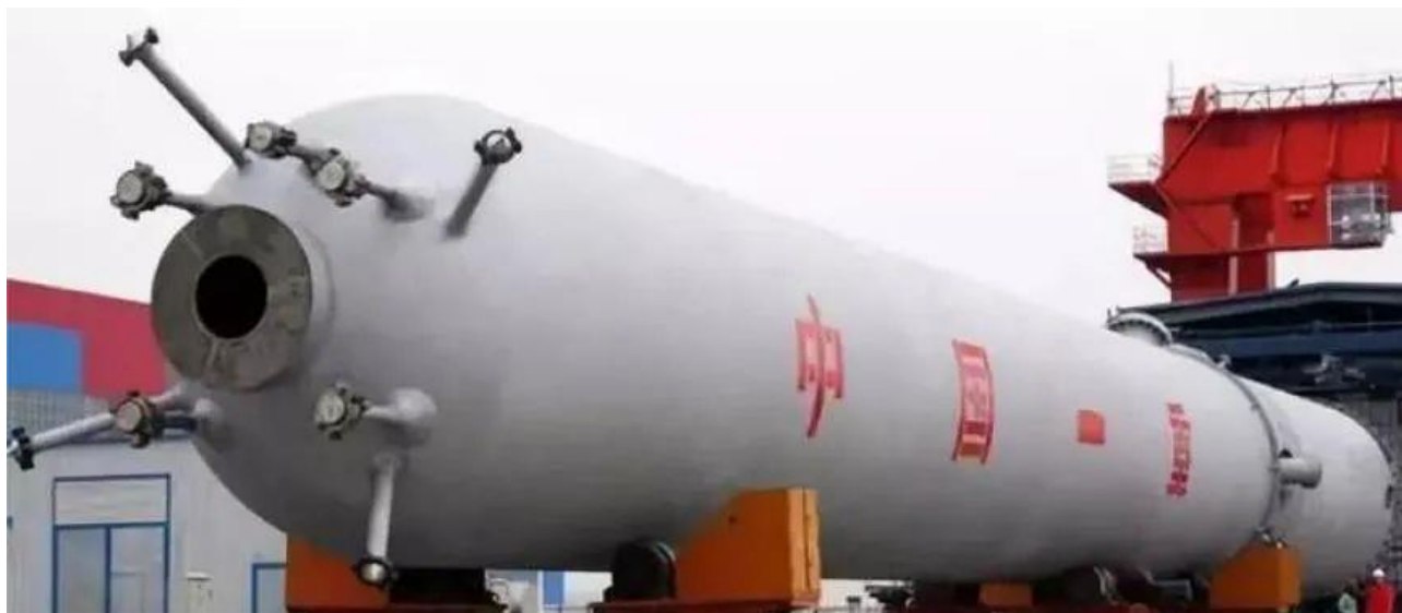
图 19 神华年产百万吨级产品的工业化示范项目使用的煤直接液化反应器
