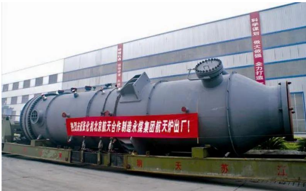
图 18 航天干煤粉气流床加压气化炉
