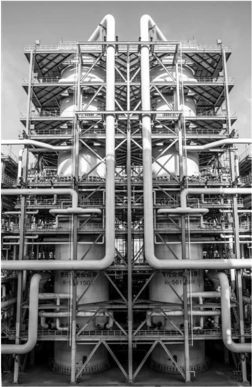
图 20 宁东 400 万 t/a 煤间接液化工业化示范项目使用的煤间接液化费托合成反应器
