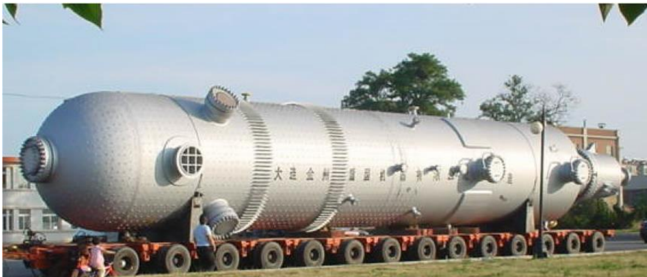
图 17 多喷嘴水煤浆气流床加压气化炉
