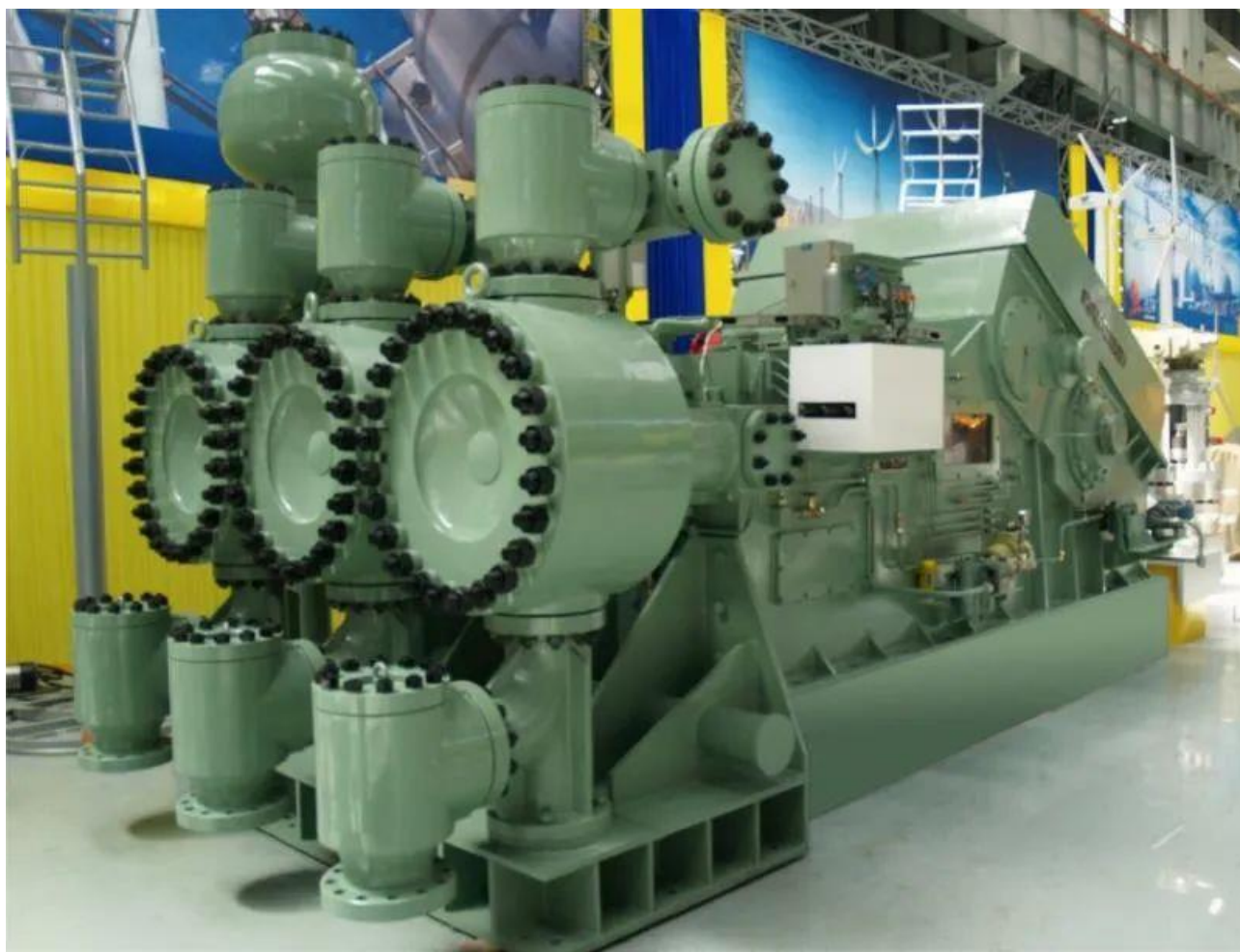
图 22 水煤浆气流床加压气化中输送高压水煤浆的隔膜泵
